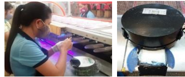
开发了一种新的化学品容器，通过接触空气来防止化学品的硬化
