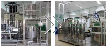
通过空气泡染色溶液循环减少了90%的危险废弃物 (活性炭过滤罐 + 蒸馏系统)
