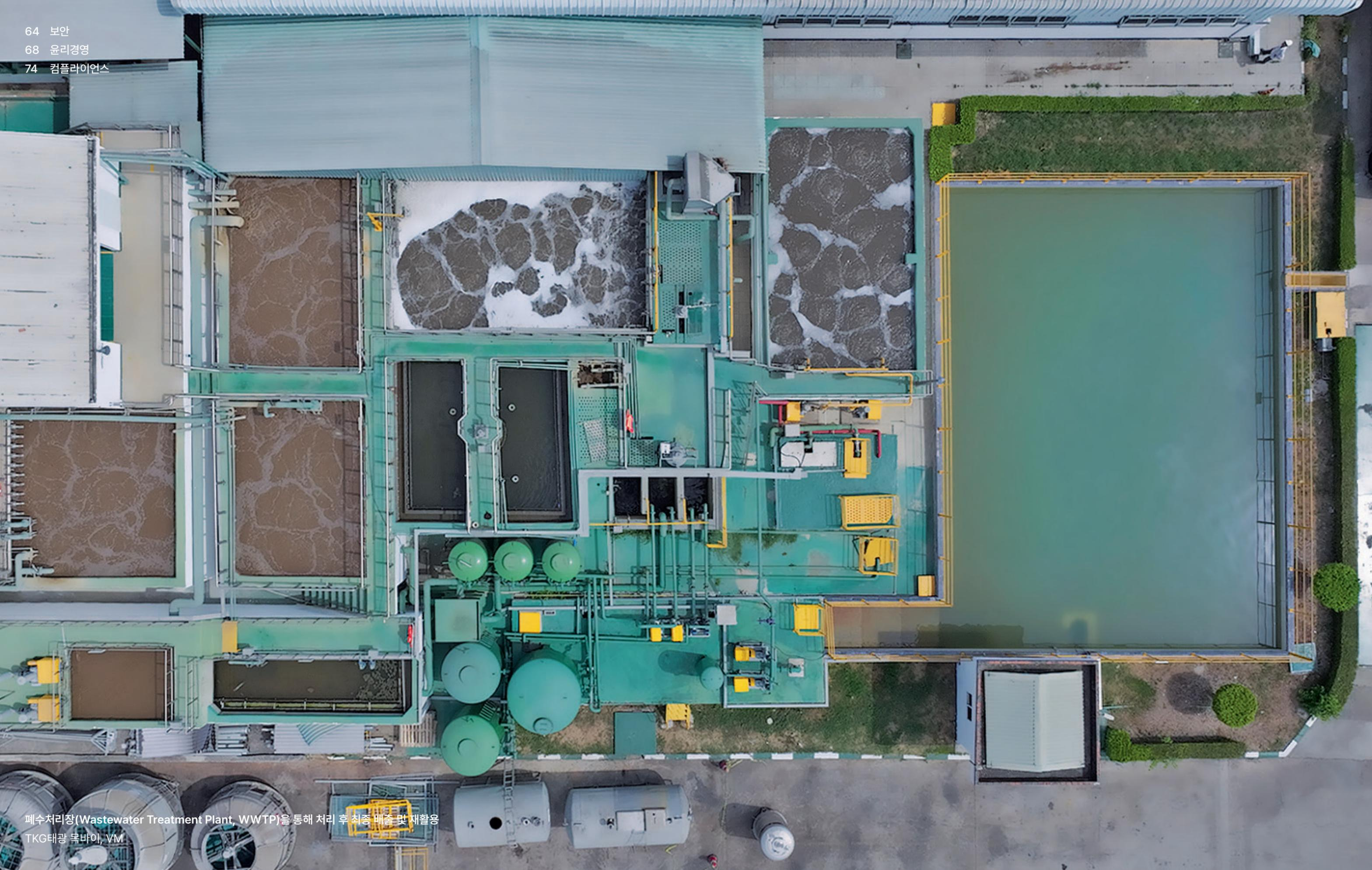
폐수처리장(Wastewater Treatment Plant, WWTP)을 통해 처리 후 최종 배출 및 재활용
