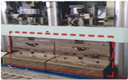
위험요소 발굴 및 개선사례 : 사출기의 안전 차단기 설치 전/후
